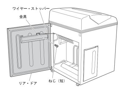
$m{4}$  ねじ(短)を外して本体側の金具とワイヤー・ストッパーを取り外します。
