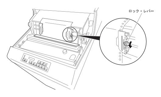
4 トラクターを左右に移動して、トラクターごと用紙をずらし、位置を調整します。
