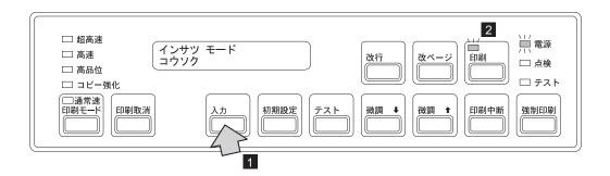
**6** 変更内容をプリンターのメモリーに書き込むため、 印刷取消 を押します 1 。メッセージ表示部 2 は次のように表示されます。
