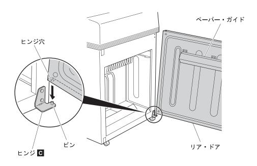
10 手順 6(2-69ページ)で取り外したヒンジ  $\square$  のピンを、リア・ドア上部のヒンジ穴に差しこみます。次に、リア・ドアを支えながらヒンジ  $\square$  を 2 本のねじ(長)で本体に取り付けます。
