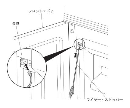
12 2-61ページの手順 3 および 4 で取り外した金具(フロント・ドア側)とワイヤー・ス トッパーを、図のようにねじ(短)で取り付けます。
