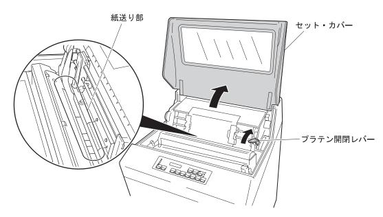
$oldsymbol{3}$  左右のトラクターに付いているロック・レバーを下方向に倒し、ロックを解除しま す。
