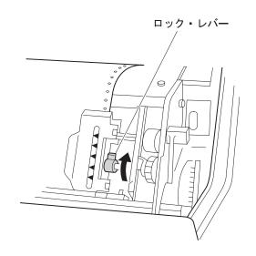
$oldsymbol{6}$  左右微調整ノブを回して用紙位置の微調整をします。このノブを回すと用紙を左右約5mmまで移動することができます。
