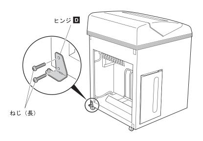
7 本体の上側と下側にそれぞれ1本のねじ(長)で固定されているマグネット受けの金 具を取り外し、反対側の位置に取り付けます。
