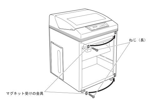
**8** 手順 5 (2-62ページ) で取り外したヒンジ **▲** を本体の下側に取り付けます。 ヒンジ 🛕 を2本のねじ(長)で左側に取り付けます。このとき、ヒンジのピンが左 側にくることを確認してください。
