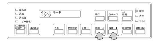
5 設定する初期設定項目と初期値を設定したら 入力 を押し 1 、初期値をIBM 5400-L06のメモリーに書き込むことを確定します。このとき、印刷ライトが点灯します 2 。
