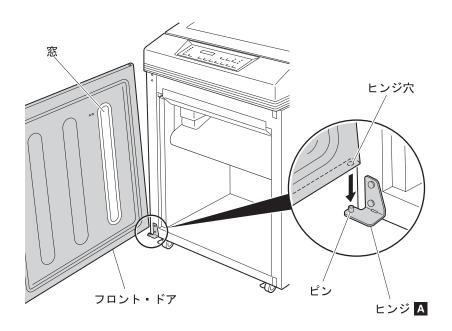
10 手順 6(2-63ページ) で取り外したヒンジ B のピンを、フロント・ドア上部のヒンジ穴に差しこみます。次に、フロント・ドアを支えながらヒンジ B を 2 本のねじ (長)で本体に取り付けます。
