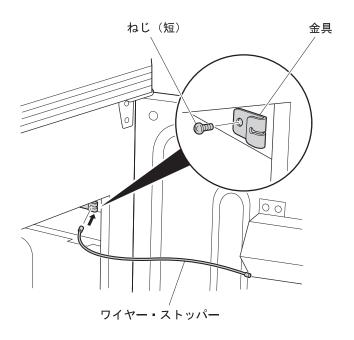
12 リア・ドア側のねじ(短)を外し、金具とワイヤー・ストッパーをねじ(短)でリ ア・ドアに取り付けます。
