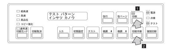
補足: テスト印字は長さ11インチ (279 mm) の用紙 1ページ分を印字すると自動的に停止します。テスト印字を途中で中止させるときは「印刷中断」を押します 2。ただし、テスト印字を途中で中止させると、先頭行位置がずれます。
