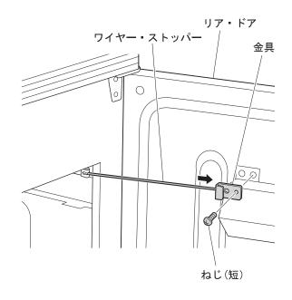
これでリア・ドアの開閉方向の変更は終了です。リア・ドアがスムーズに開閉できることを 確認してください。スムーズに開閉できない場合は、ヒンジの固定位置を調整してくださ い。
