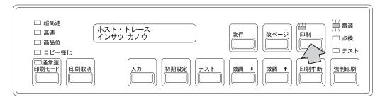
**5** ホスト・トレースを終了するときは、「印刷中断」を押してから「印刷取消」を押しま す。電源投入直後の状態に戻ります。
