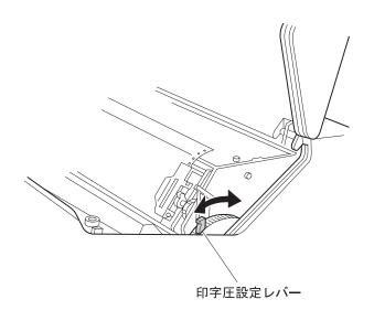
2-52ページの表を参考にして、印字圧設定レバーの位置を用紙の種類に合わせて設定してください。
