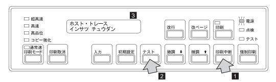
[印刷]を押します。印刷ライトが点灯し、ホスト・トレースのデータ受信が可能にな ります。
