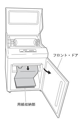
$oldsymbol{8}$  用紙の調整が完了したら、プラテン開閉レバーを手前に引いて紙送り部を閉じ、セッ ト・カバーとフロント・ドアを閉めます。
