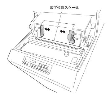
**5** 用紙の位置が決まったら、左右のトラクターのロック・レバーを上げ、トラクターをロックします。このとき、用紙がたるまないようにします。
