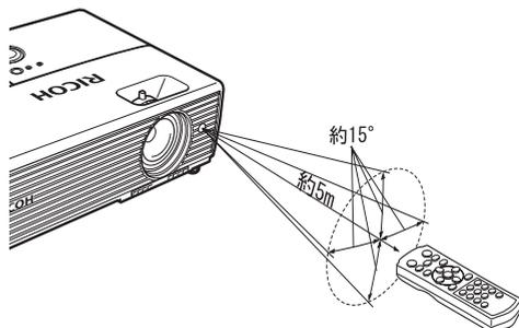
本機の後方からリモコン操作する場合、投写面の反射を利用しての操作になりますので、投写面の形状や材質によって到達距離が短くなります。
