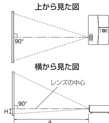
aはレンズからスクリーンまでの距離(m)で、0.89 m~10.93 m の範囲に対応します。
