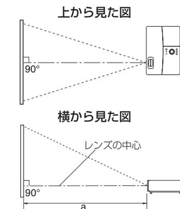
a はレンズからスクリーンまでの距離(m)で、0.94 m~11.58 m の範囲に対応します。
