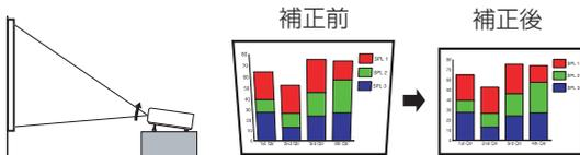
プロジェクターの設置角度にあわせて自動的に台形補正が行われます。
