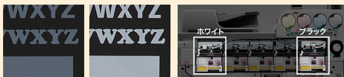
オフセット印刷(一度刷り)によるホワイト印刷 RICOH Pro C7210S (一度刷り)によるホワイト印刷
